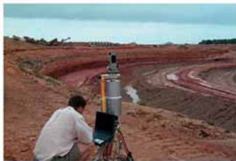
Рисунок 1 - Наземная сканирующая система
