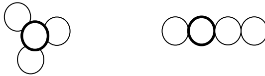
Рисунок 9 – топология связей четырёх связанных кусочно-плоскостных объектов.
