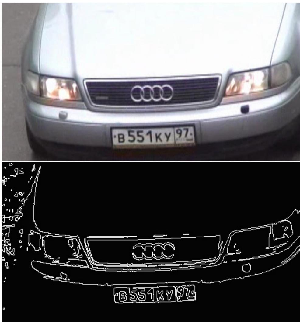
Рисунок 10 – Результат работы алгоритма выделения контуров
